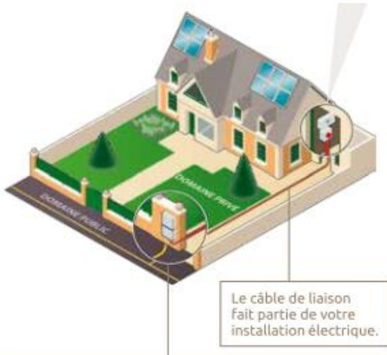
Si le compteur de consommation n'est pas un compteur Linky, Enedis doit le remplacer : un unique compteur mesure ainsi les énergies consommée et produite. Compteur, disjoncteur et coupe-circuit principal sont installés dans un double coffret de branchement en limite de propriété.
